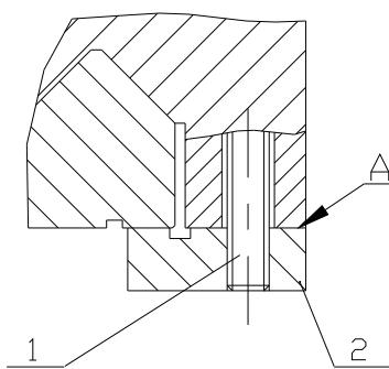
Фиг.15.9.1 Наладка зазора со стороны "V" направляющей
