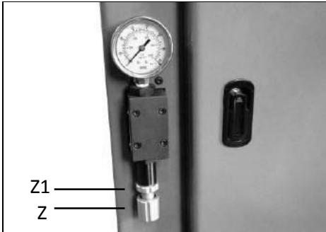
Датчик гидравлического давления тисков расположен на задней стороне основания.
