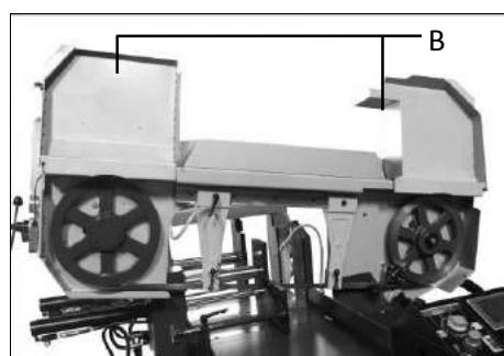
Откройте защитные крышки пильного полотна (B). Ослабьте натяжение твердосплавных направляющих путем поворота ручки (C) против часовой стрелки на 1/4 оборота.
