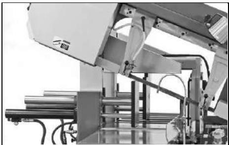
Система зажима заготовки состоит из неподвижных и подвижных тисков. Подвижные тиски осуществляют подачу заготовки, позиционирование, обеспечивают дополнительную поддержку при зажиме. Обе губки подвижных тисков приводятся в движение гидравлическим приводом. Эта система позволяет гибко и безопасно зажать заготовки неправильной формы. На подвижных и неподвижных тисках имеются вертикальные прижимы для зажима и резки пакетов.
