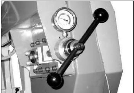
Поверните рукоятку натяжения пильного полотна, чтобы увеличить натяжение полотна, до требуемых показаний на манометре. Ослабьте натяжение в том случае, если полотно долгое время не используется.
