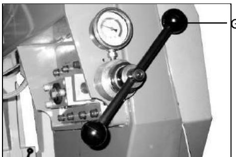
Ослабьте натяжение пильного полотна. Поверните ручку натяжения полотна (G) против часовой стрелки, пока полотно не освободится.
