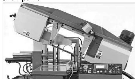
Пильная рама включает в себя части привода (двигатель-редуктор или двигатель с регулируемой частотой вращения, шкивы, маховики), систему натяжения, пильное полотно, направляющее устройство (направляющие рычаги и направляющие блоки) и лампу рабочего освещения.
