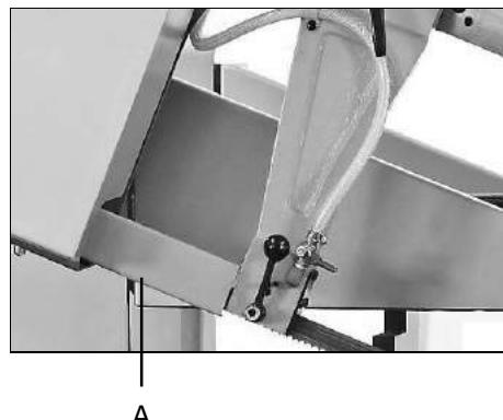
Снимите оба защитных кожуха пильного полотна (A), закрепленных на направляющей пильного полотна и защитной крышки.
