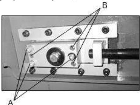
Найдите крепление оси неприводного шкива на задней стороне пильной рамы. Это прямоугольный блок с тремя винтами с головками под шестигранный ключ (A) и тремя винтами (B), расположенные в углублениях.
