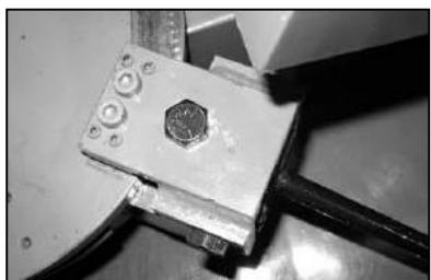
Поднимите рычаг блокировки. Ослабьте крепежные винты с головками под шестигранный ключ (B). Затяните все 4 установочных винта (A) до упора. Ослабьте установочные винты (A) на  $\frac{1}{4}$  оборота. Затяните винты с головками под шестигранный ключ (B). Покрутите пильную раму вперед-назад примерно на 45 °, чтобы проверить, перемещается ли она свободно, и нет ли чрезмерного трения поверхности поворотного устройства (система, соединяющая пильную раму с основанием).
