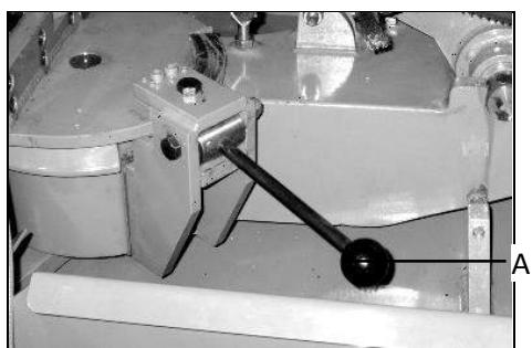
Блокируйте вращение системы перед выполнением любых операций на станке. Разблокируйте вращение пильной рамы. Поднимите рычаг блокировки (A). Поверните пильную раму. Проверьте угол по шкале. Установите желаемый угол резания по шкале. Зафиксируйте пильную раму в установленном положении. Опустите рычаг блокировки (A).
