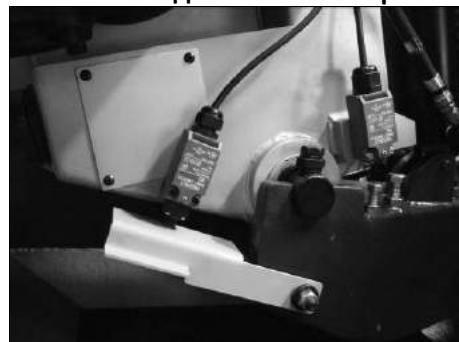
Регулировочная пластина, которую можно легко настраивать вручную в зависимости от диаметра материала так, чтобы зубья пильного полотна находились примерно в 15 - 20 мм от поверхности заготовки для уменьшения времени рабочего цикла.
