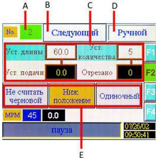
A Номер выполняемого шага программы. Шаги программы можно запрограммировать на экране F3
