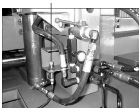
Когда подвижные тиски достигли крайнего положения при перемещении вперед, датчик посыпает контроллеру сигнал на выполнение следующего действия.
