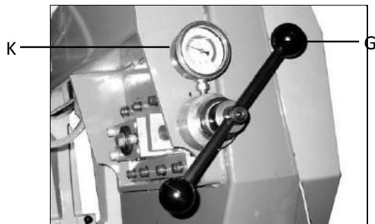
После установки полотна, поверните ручку натяжения полотна (G) по часовой стрелке, пока стрелка манометра натяжения (K) не перейдет в зеленую часть шкалы.
