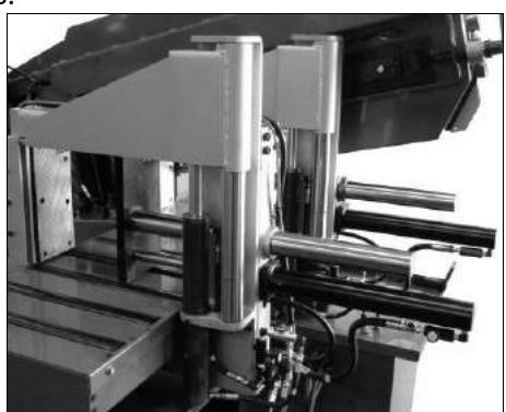
Это позволяет резать несколько заготовок сразу. Зажим осуществляется гидравлическим приводом автоматически. Чтобы отключить систему, просто откройте тиски, подождите, пока вертикальные тиски поднимутся до верхней позиции, а затем
