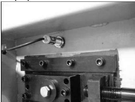
Станок оснащен устройством автоматического выключения питания для предотвращения дальнейшего ущерба в случае разрыва пильного полотна. Магнитный датчик отслеживает движение неприводного шкива пильного полотна. Когда полотно разорвано или плохо натянуто, шкив не вращается.
