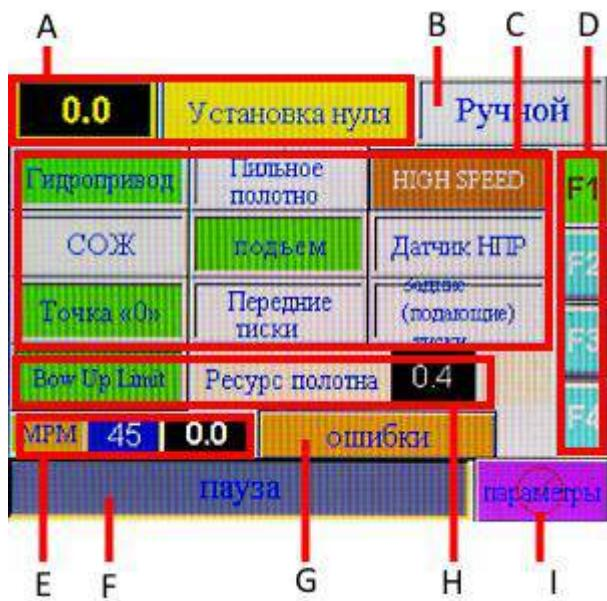
I Параметры станка были настроены при его производстве. Чтобы попасть на эту страницу введите пароль и нажмите ENT для ввода пароля в систему. Нет необходимости вносить какие-либо изменения в настройки параметров. Все изменения параметров должны производиться квалифицированным персоналом или специалистами нашей компании. При внесении любых изменений в параметры системы необходимо быть предельно внимательным, т.к. неправильные параметры системы могут привести к сбоям в работе станка.
