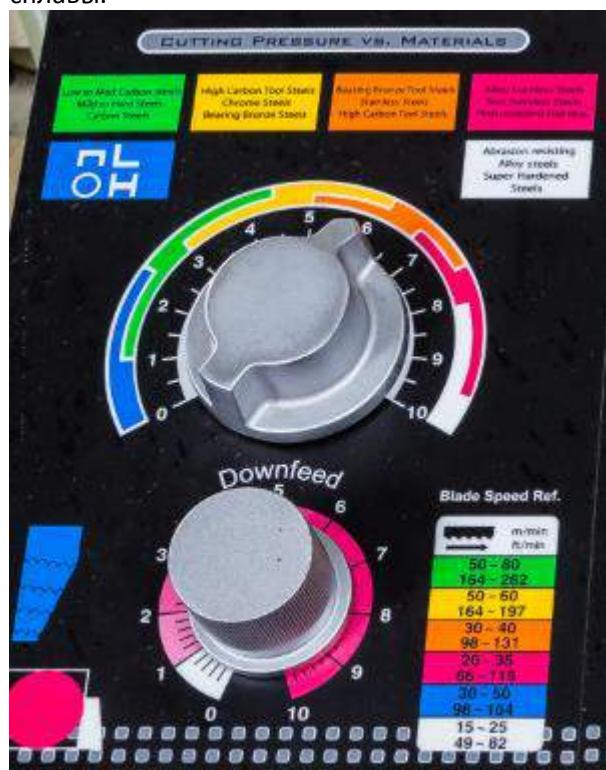
Установите величину давления и скорость движения полотна согласно приведенным рекомендациям. Скорость опускания пильной рамы определяется эмпирически, по характеру образующейся стружки.
