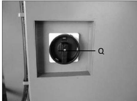
Подключите питание станка, используя переключатель Q, расположенный на тумбе под панелью управления.
