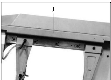
В верхней части пильной рамы, пильное полотно проходит по защитному желобу (J).
