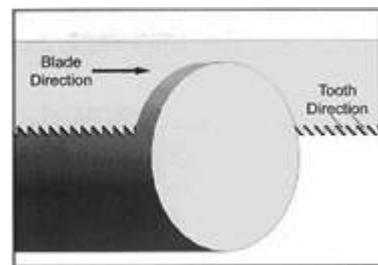
Зубья, когда они проходят по твердосплавным направляющим, должны быть повернуты в направлении привода. Зубья полотна должны выступать на 4,5-5мм за обод шкива.
