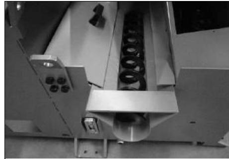
Гидравлический двигатель вращает шнек удаления стружки. Он запускается автоматически во время цикла резания.
