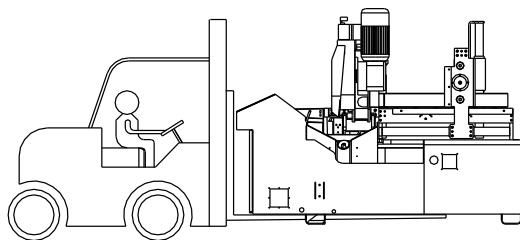
Осторожно распакуйте станок и установите его в нужном месте, используя кран или вилочный погрузчик. Если для подъема станка используется кран, надежно закрепите подъемный трос к станку. Обеспечьте достаточное пространство вокруг станка для безопасной подачи материала в станок, проверки и технического обслуживания станка. На станок не должны влиять вибрации и пыль, возникающие в результате работы другого оборудования, учитывайте это при выборе места установки.
