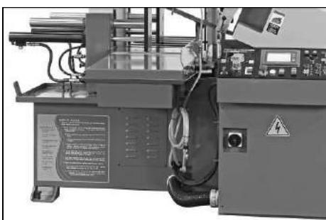
Основание служит для установки на него пильной рамы (точки поворота пильной рамы и соответствующих систем блокировки), тисков, роликов, системы подачи и системы охлаждения.
